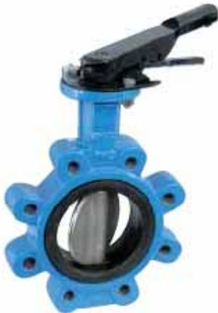
Valvole di intercettazione a farfalla tipo LUG con orecchie filettate, complete di leva di manovra fino al DN80 e di volantino per diametri superiori. Su richiesta è possibile ordinare i contatti di fine corsa, per il monitoraggio dello stato ON/OFF della valvola: supporti per leva con due contatti di fine corsa per valvole con leva di manovra di diametro fino al DN100, riduttore manuale con due contatti di fine corsa per valvole aventi diametro superiore al DN100.
